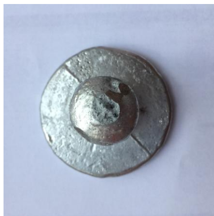
Рис. 1. Внешний вид излома композиционного материала Al-TiC, полученного с помощью термитной смеси
