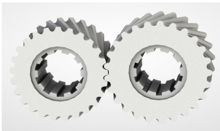
Рис. 2. 3D-модель зацепления Новикова с ОЛЗ
