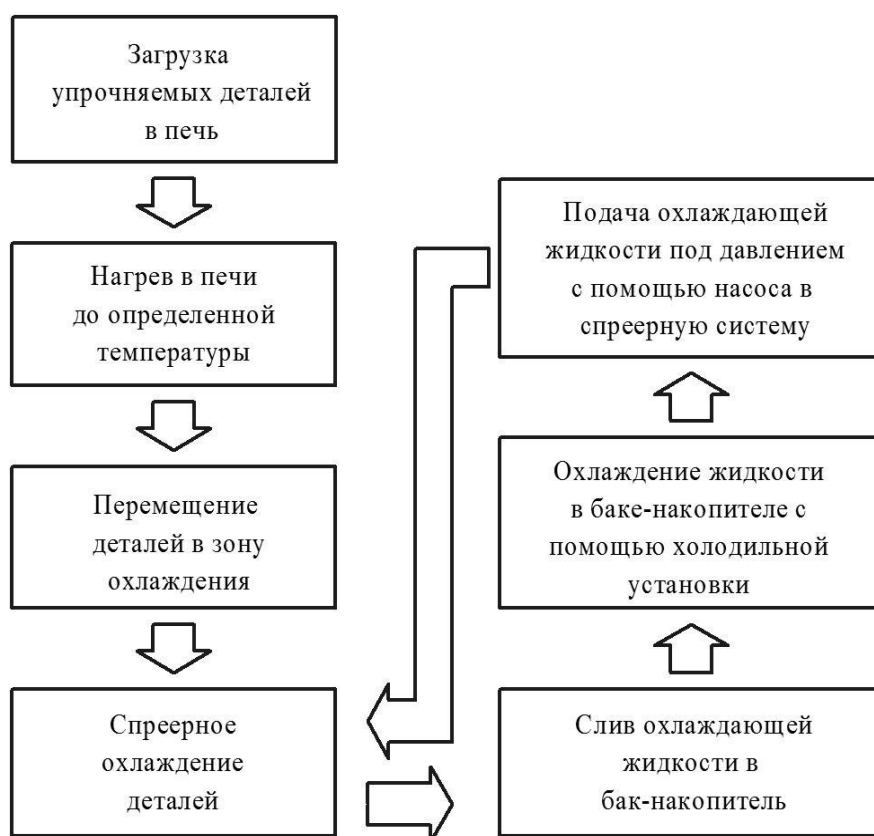
Рис. 1. Технологический процесс термопластического упрочнения детали (блок-схема)
