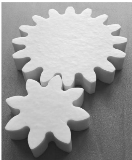
Рис. 3. Зубчатое колесо и шестерня в эвольвентном зацеплении, полученные контурным фрезерованием
