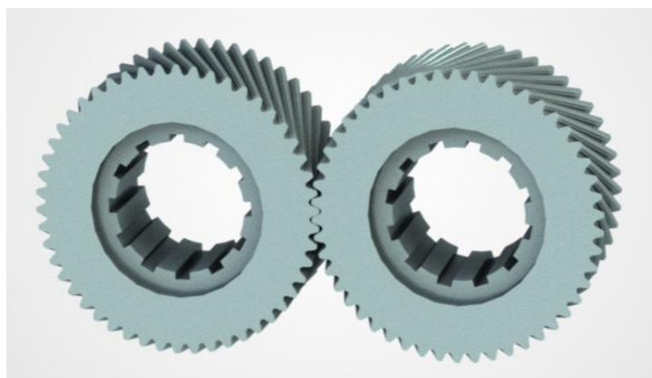
Рис. 3. 3D-модель зацепления Новикова с ДЛЗ
