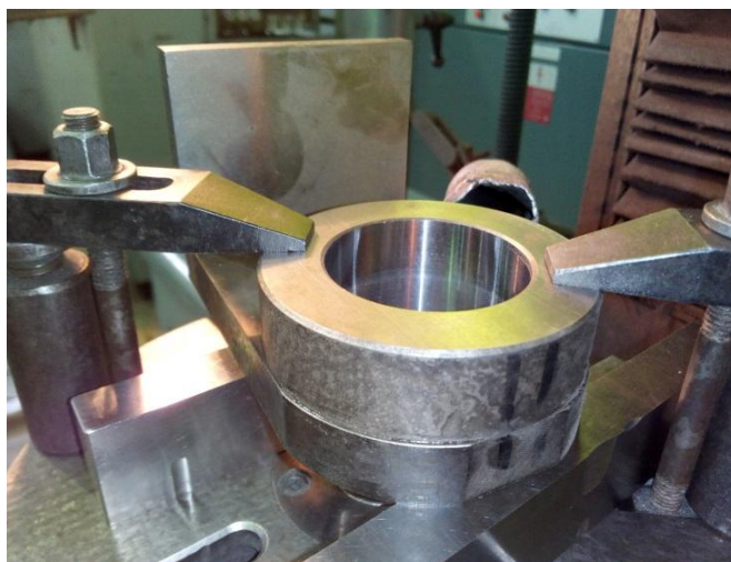
Рис. 5. Обработанная поверхность из 40Х 52...55HRC
