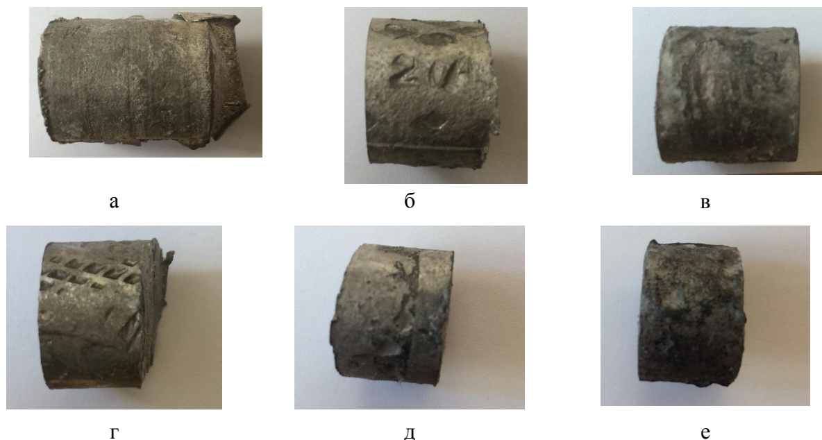
Рис. 1. Образцы после испытаний на коррозионную стойкость: а – Al (A7); б – (Al-5%Cu); в – (Al-5%Cu-4%Ni); г – Al-10%TiC; д - (Al-5%Cu) -10%TiC; е - (Al-5%Cu-4%Ni) -10%TiC
